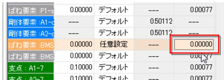
解析を行う全てのランに対して、上記減衰パラメータの設定を行う必要がある。設定が終了したら固有値解析を行わずに、時刻歴応答解析を実行する。
