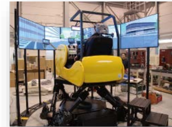
情報利用型人間-自動車-交通流 相互作用系シミュレーションシステム
