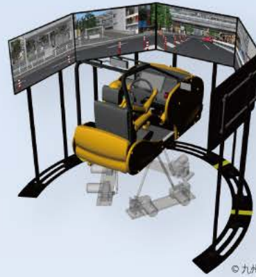
情報利用型人間-自動車-交通流相互作用系シミュレーションシステム
